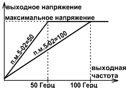
Рисунок 17. Зависимость выходного напряжения от номинальной частоты двигателя.
