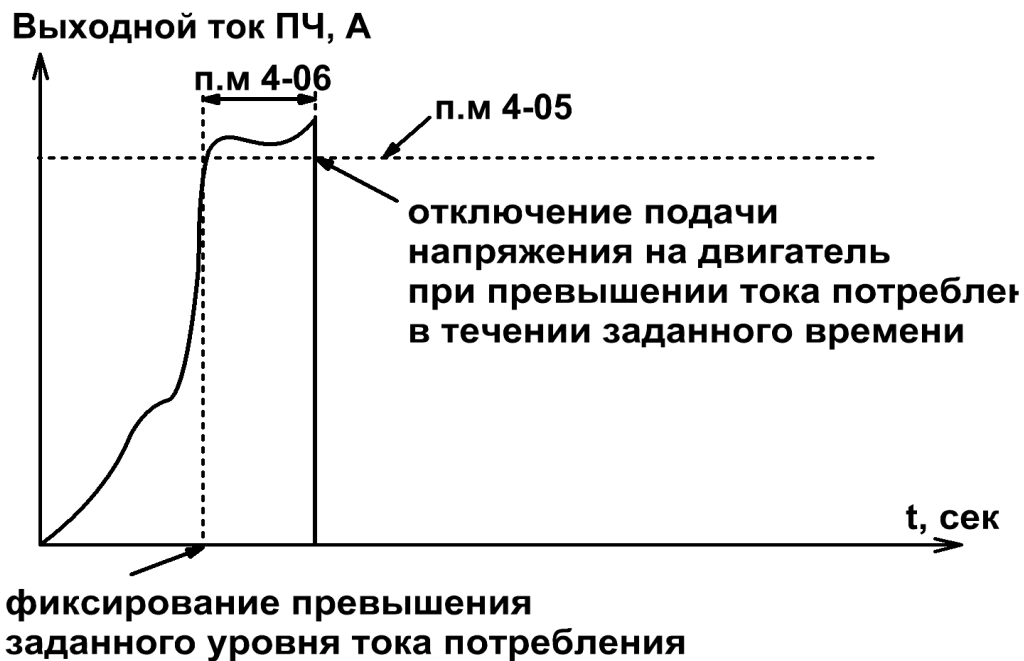
Рисунок 5. Срабатывание защиты при токовых перегрузках по времени.
